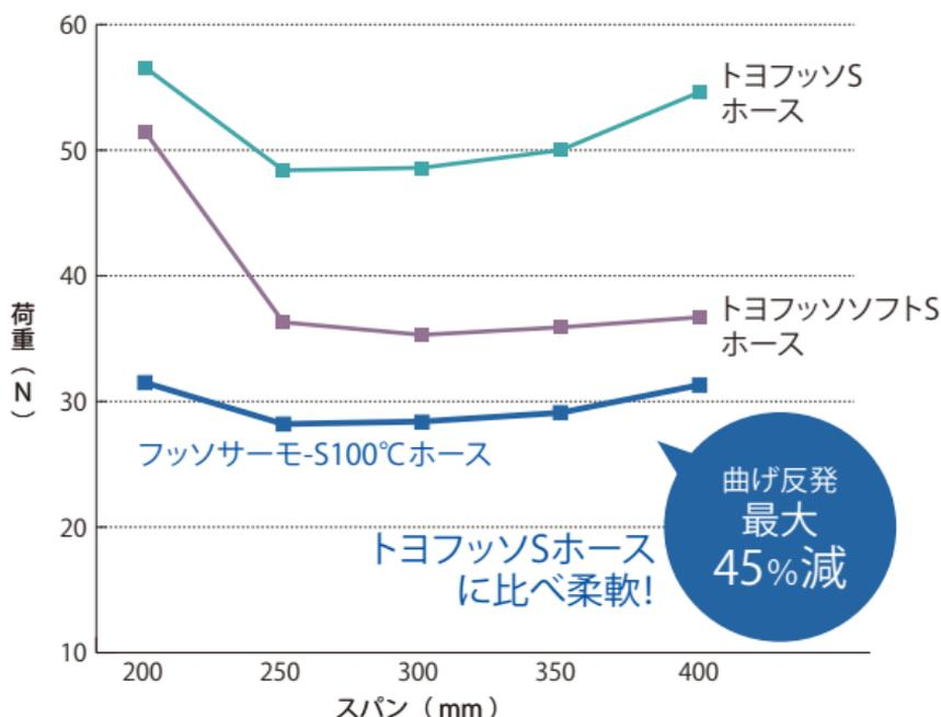
試験方法：（トヨックス規格試験）ホースサイズは全て25φとする。
